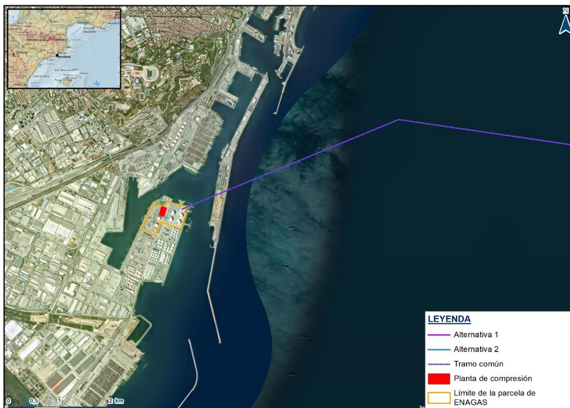
Figura 8. Zona de atarraje y planta de compresión
