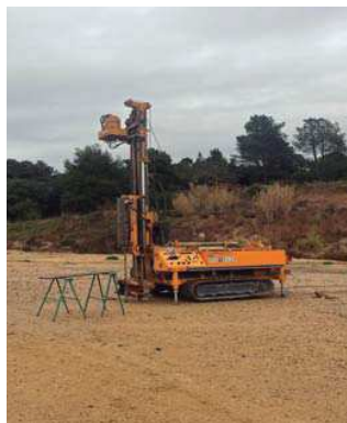
Execució dels assaig de penetració P1 i P2, i central de dades de l'equip de pressiometria Ménard.
