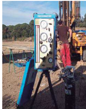
Execució dels assaig de penetració P1 i P2, i central de dades de l'equip de pressiometria Ménard.
