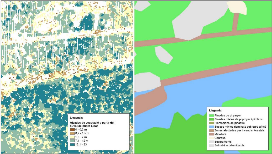
Figura 2.1 Comparativa entre el núvol de punts LiDAR (imatge esquerra) i les tipologies forestals resultants del treball realitzat (imatge dreta). Font: Elaboració pròpia a partir de la cartografia del ICGC.
