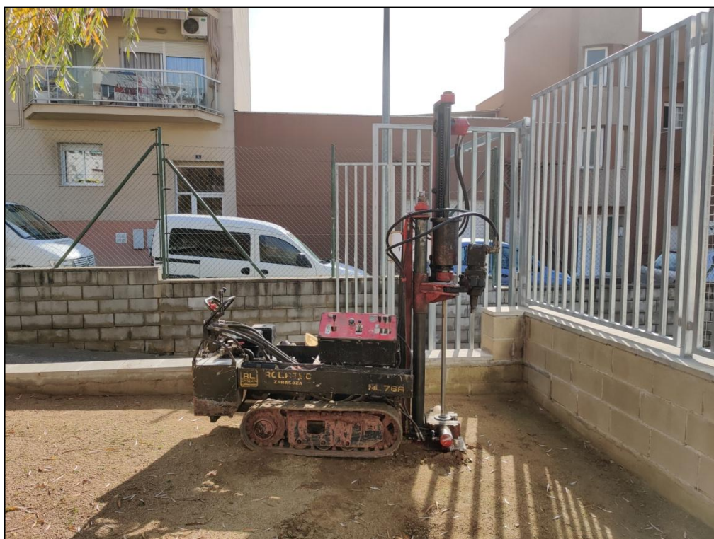
Vista penetròmetre nº 6
