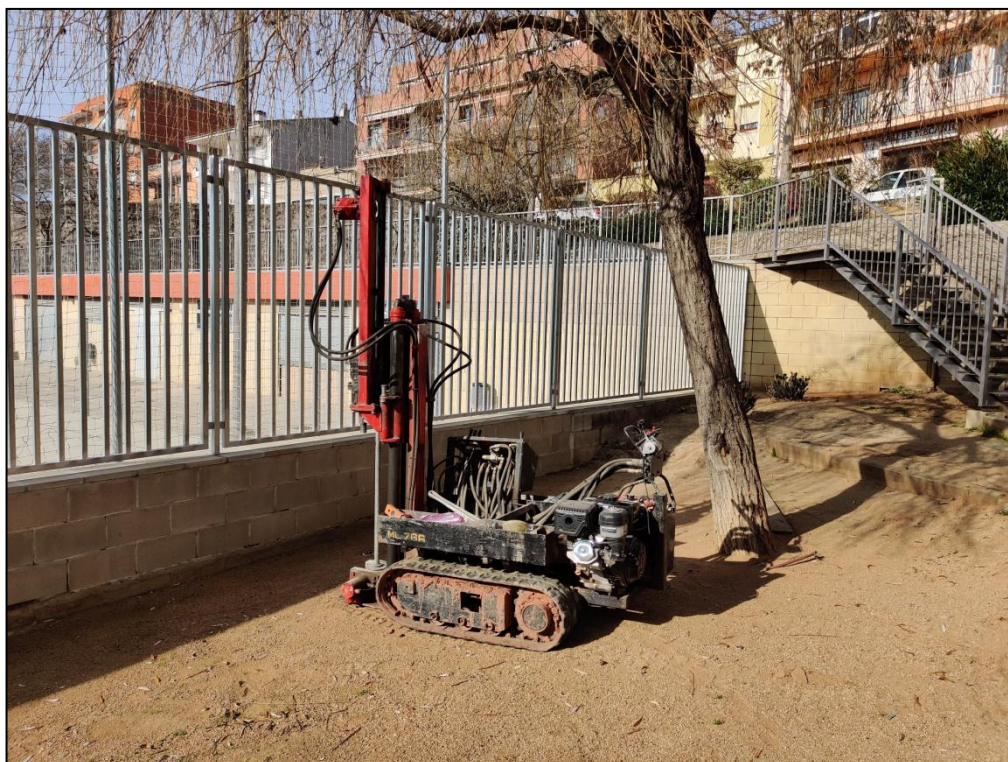
Vista penetròmetre nº 5
