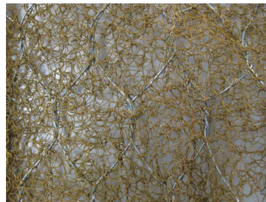
DETALL GEOMALLA TRIDIMENSIONAL POLIMÈRICA AMB XARXA DE TRIPLE TORSIÓ (PER APLICACIÓ EN ZONES MENYS ROCOSES) SENSE ESCALA
